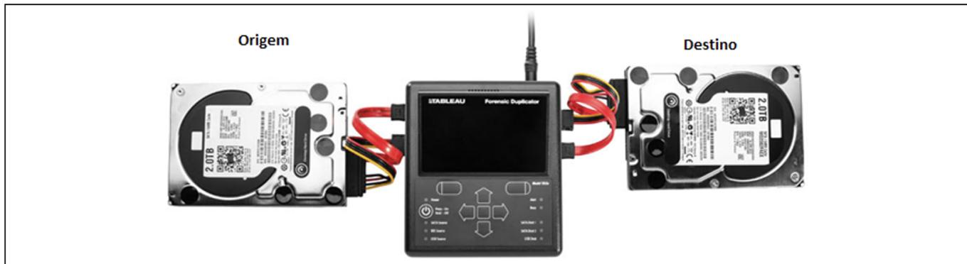
Figura 24 - Duplicador de dispositivos de armazenamento
